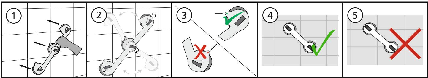
© Bad-Wandhaltegriffe AMPPEL Das Ampel-System an jedem Saugsteller zeigt Ihnen an, ob der Griff noch über sichere Haftung verfügt (Grün) oder ob der Sauger neu angesetzt werden muss (Rot).
